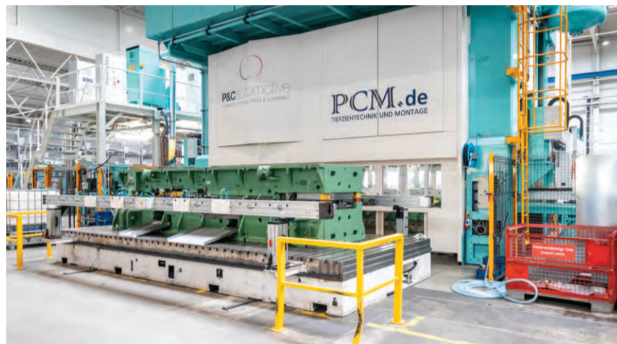
PCM de Germania: Pressa 2000 ton con bancale 6500x2500mm automatizzata
