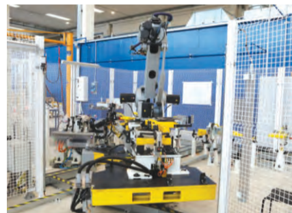
PCM it Teramo (IT): Impianto di lastratura per scocca automotive
