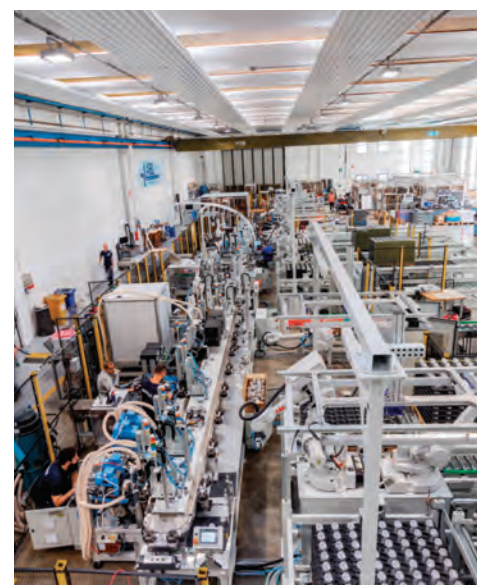
linea semiautomatica di montaggio gruppo scambiatore per autoveicoli
